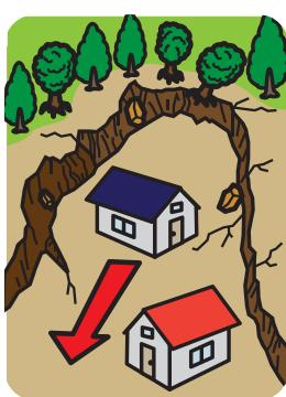
斜面の一部あるいは全部が地下水の影響と重力によってゆっくりと斜面下方に移動する現象。
